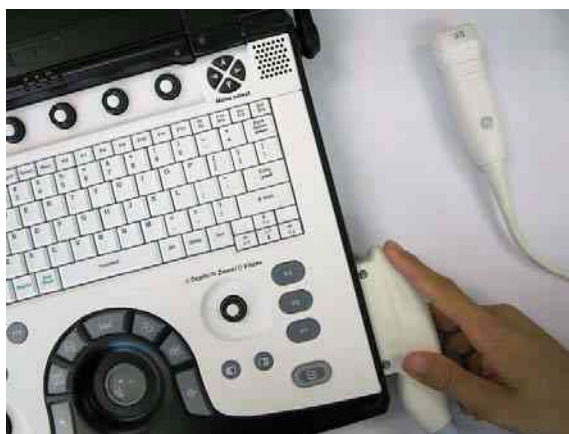
Рис. 1-13. Подсоединение датчика к системе LOGIQ e
