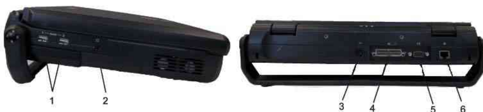
Рис. 1-6. Панель разъемов для подключения периферийных/дополнительных устройств
