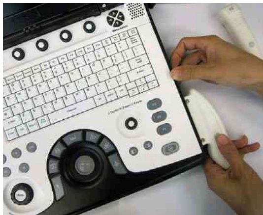
Рис. 1-14. Рычаг фиксации разъёма датчика
